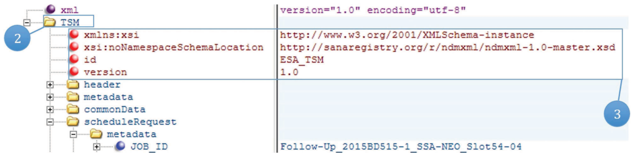
Bild 3 — XML-Dokumentdeklaration und Attribute des Wurzelements
