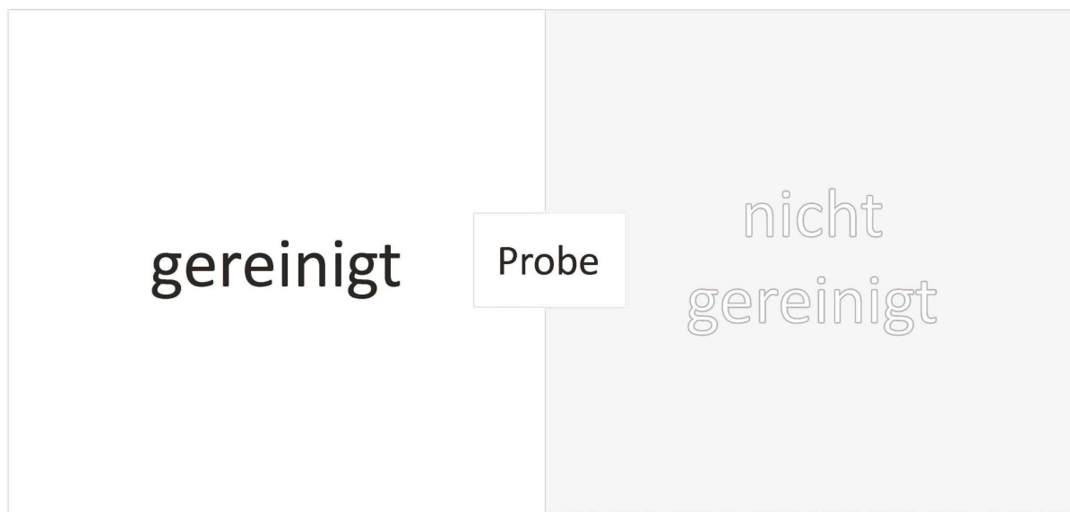
Bild 3 — Schematische Darstellung des Versuchsbereichs und der Probenahme eines Fragments zu Herstellung von Schliffen (Dünnschliffe oder polierte Schliffe). Größe des Versuchsbereichs 10 cm × 5 cm. Größe der gereinigten Fläche 5 cm × 5 cm. Größe der nicht gereinigten Fläche 5 cm × 5 cm
