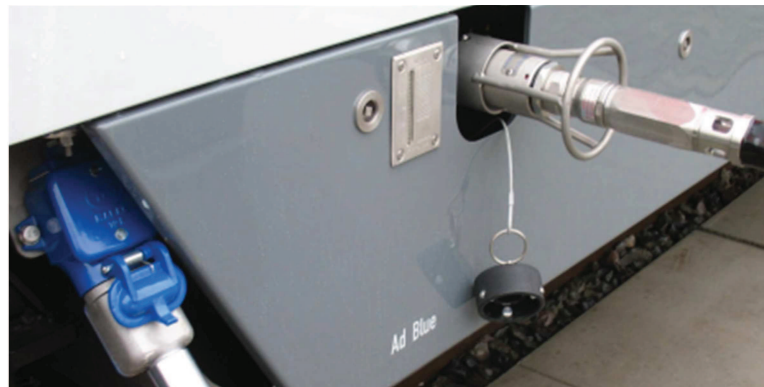
Bild 1 — Typischer Einbau der AUS 32-Kupplung und des elektrischen Steckverbinders
