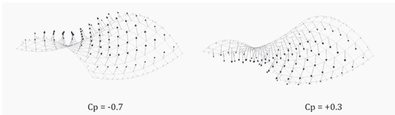
Bild 3 — Druckkoeffizienten von freistehenden doppelt gekrümmten lasttragenden Membranstrukturen
