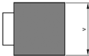
Bild 6 — Kritische Maße von Notausgangsschlössern Typ C
