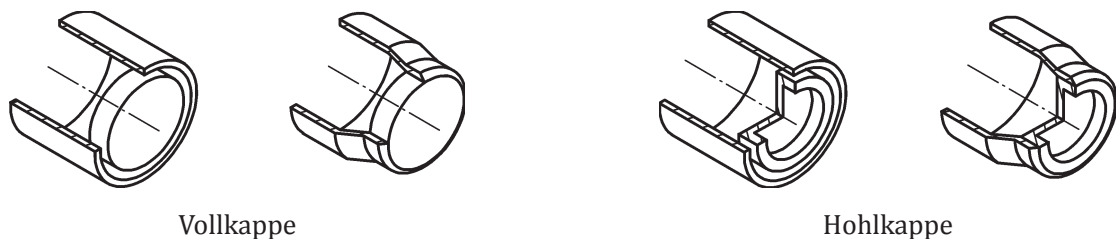
Bild 8 — Geometrie der Kapselschweißung
