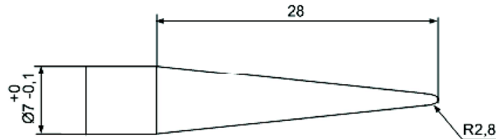
Bild 4 — Prüffinger für Maschengeflecht
