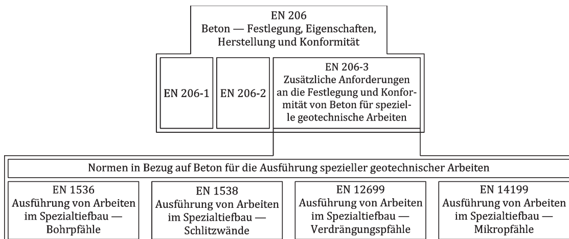
Bild 1 — Zusammenhang zwischen prEN 206-3 und den Normen für die Ausführung spezieller geotechnischer Arbeiten — Normen in Bezug auf Beton
