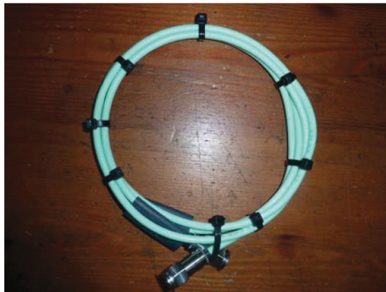
Bild 1 — Koaxialkabel mit Kabelbindern und Schlaufe mit festgelegtem Durchmesser
