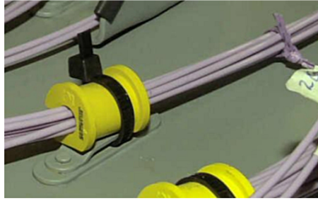
Bild 1 — Spulen für Kabelbäume von Lichtwellenleitern
