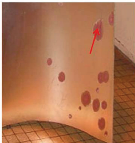
Bild C.6 — Übertragung von Spritzern aus der Gussform auf das Produkt
