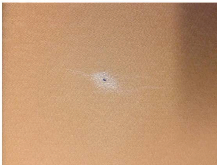
Bild C.3 — Einschluss auf der Oberfläche
