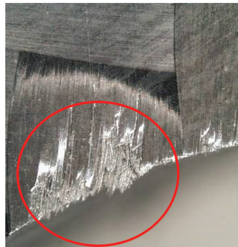
Bild D.4 — Abblättern an der Kante eines Bohrlochs
