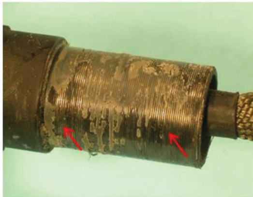
Bild B.1 — Bereiche mit fehlendem Klebstoff
