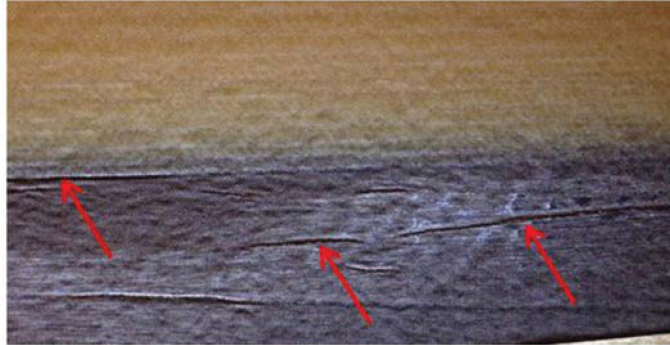
Bild D.9 — Druckstellen, die durch eine Trennlage verursacht wurden
