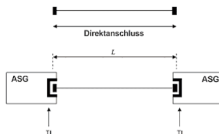
Bild 2 – Konfiguration eines Direktanschlusses
