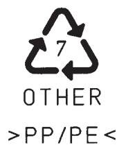
Bild 2 – Kennzeichnung von Polypropylen
