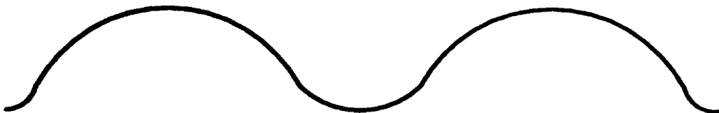
Bild 5 — Teil eines typischen Wellblechprofils
