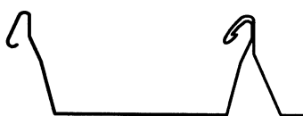
Bild 6 — Typisches Profil mit Stehfalz
