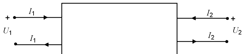
Bild 1 – Vereinbarungen über Vorzeichen in Stromkreisen N7)
