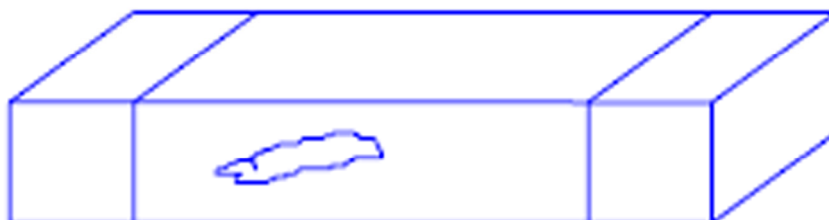
Bild 1 – Fehler: Riss oder Spalte
