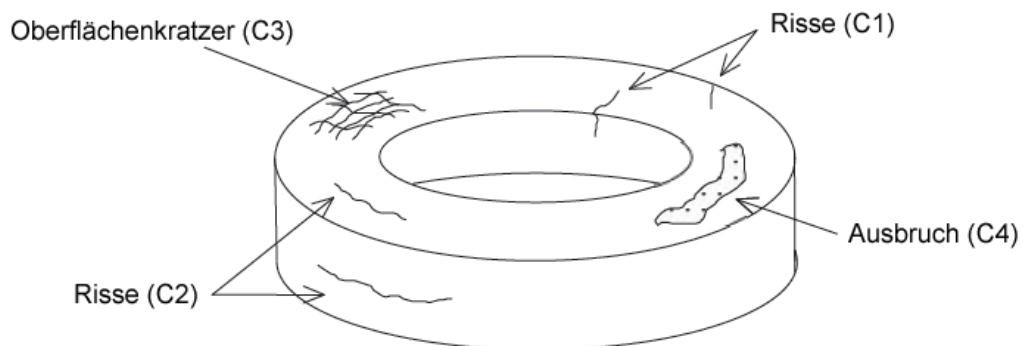
Bild 2 – Lage von Rissen und Ausbrüchen an Ringkernen
