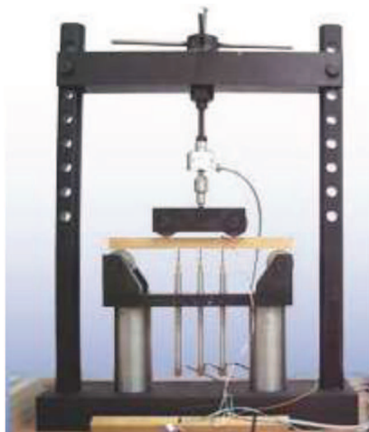
Bild 6 – Prüfaufbau (links) für die Vier-Punkt-Biegeprüfung mit Darstellung der Querkraft- und Biegemomentwirkung (rechts)
