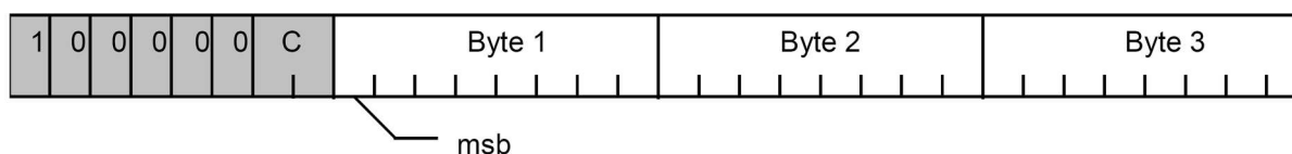
Bild 8.11 – Format der MIDI-konformen Daten
