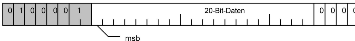
Bild 8.10 – Anpassen von 20-Bit-Daten in einem 24-Bit-Feld
