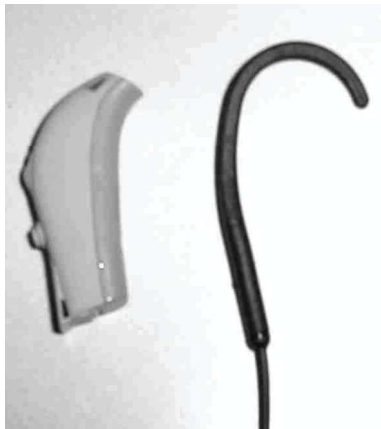
Bild 1 – Ein Induktionswandler vom Typ Ohrbügel mit einem HdO(Hinter dem Ohr)-Hörgerätegehäuse als Größenvergleich
