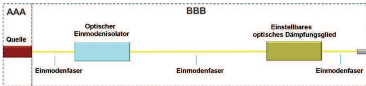
Bild 2 – Empfohlener Messaufbau für Einmodenfaser-Einkopplungsbedingungen
