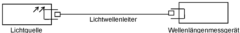
Bild 1 – Messaufbau für die Kalibrierung der Eigenwellenlänge
