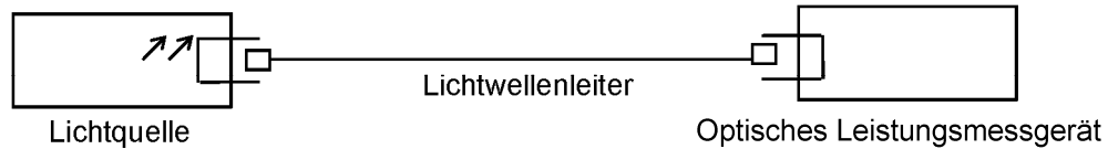
Bild 7 – Messaufbau für die Stabilität der optischen Leistung
