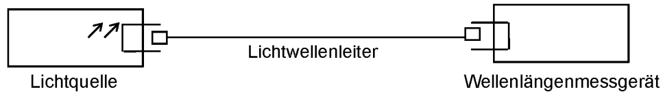
Bild 3 – Messaufbau für die Stabilität der Wellenlänge
