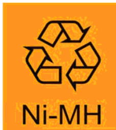
Bild 8 – Beispiel der Kennzeichnung mit dem Recyclingsymbol für Nickel-Metallhydrid-Batterien
