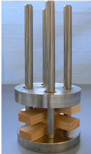
Bild 3 — Beispiel eines Halters, um die Proben zu belasten
