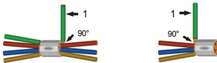
Bild 33 – Biegeprüfung an Spleiß-Crimpverbindungen
