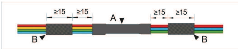
Bild 15 – Isolierungsmaßnahmen am durchgehenden Spleiß von einem Leiter auf mehrere Leiter
