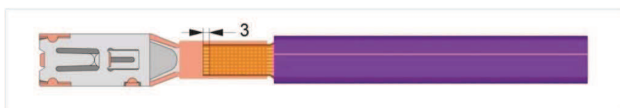
Bild 28 – Messung der Schweißbreite (2)
