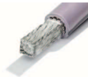
Bild 38 – Endspleiß einer einzelnen Litze (kompaktiertes Litzenende)
