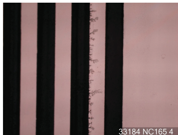
Bild 2 – Beispiel für eine von hinten beleuchtete Prüfprobe mit Dendritenwachstum
