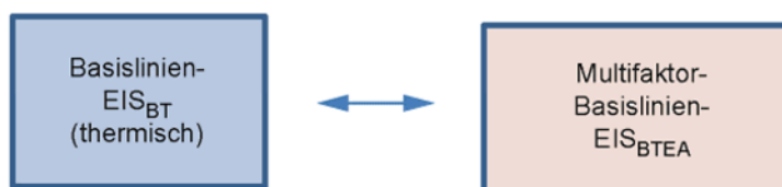
Bild 5 – Vergleich des Einflusses von unterschiedlichen umgebungsbedingten/umweltbedingten Beanspruchungen, die während der thermischen Beanspruchung aufgebracht werden, mit der thermischen Basislinien-Auslegung
