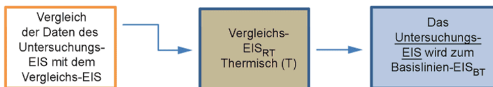
Bild 2 – Darstellung der Festlegung der thermischen Klassifizierung des Basislinien-EIS
