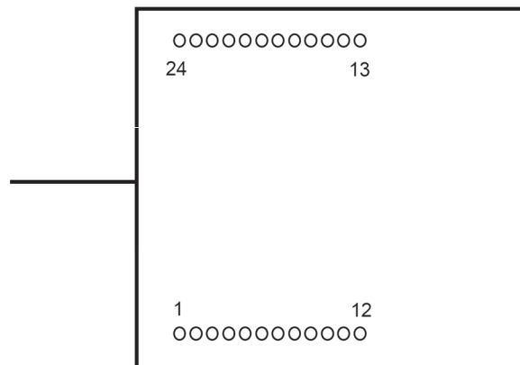
Bild 1 – Nummernzuordnung der elektrischen Anschlüsse (Draufsicht auf das Modul mit den Stiften auf der Unterseite)
