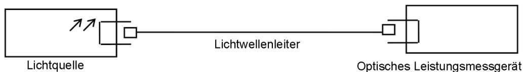
Bild 7 – Messaufbau für die Stabilität der optischen Leistung
