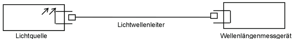
Bild 1 – Messaufbau für die Kalibrierung der Wellenlänge
