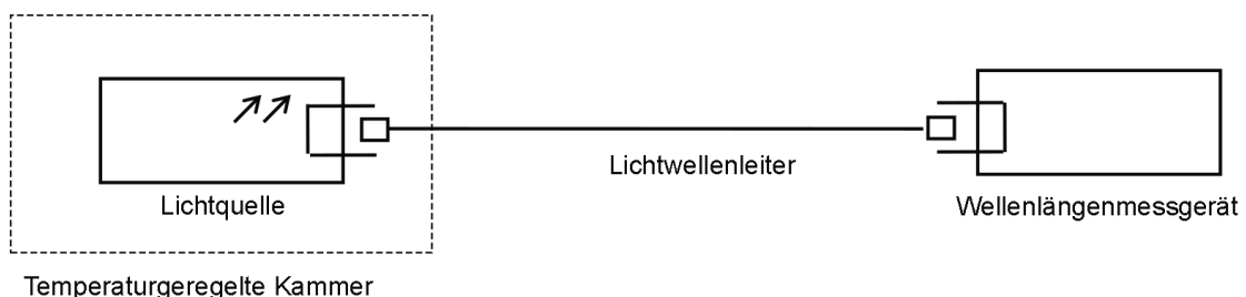
Bild 2 – Messaufbau für die Temperaturabhängigkeit
