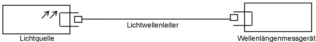
Bild 3 – Messaufbau für die Stabilität der Wellenlänge
