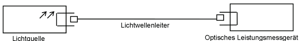
Bild 8 – Messaufbau für die Verbindungswiederholpräzision/-reproduzierbarkeit
