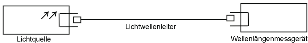
Bild 4 – Messaufbau für die Abhängigkeit von der optischen Leistung
