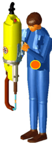
Bild 3 – Expositionsmessung am Rumpf
