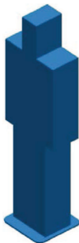
Bild 4 – Perspektivische Darstellung des Prüfdummys
