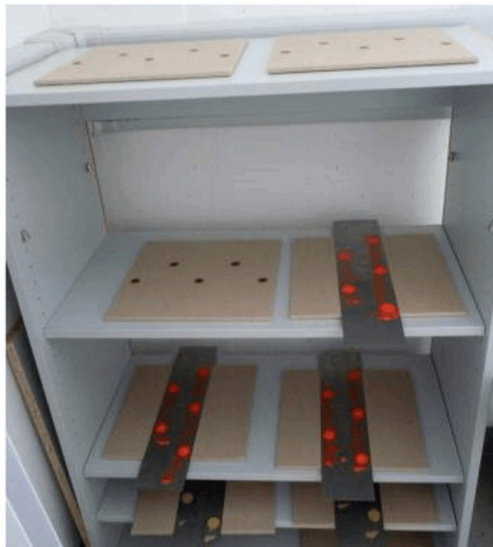
Bild 3 – Fliesentrocknungsgestell zum Vorbereiten und Trocknen von Anschmutzungsflecken
