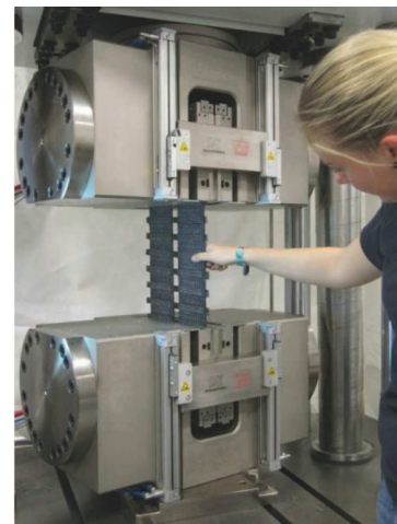
d) Beispiel für hydraulische Backen für Produkte mit hoher Zugfestigkeit
