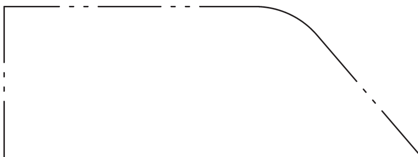
Bild A.10 — Strich-Zweipunktlinie (langer Strich) mit Richtungswechsel
