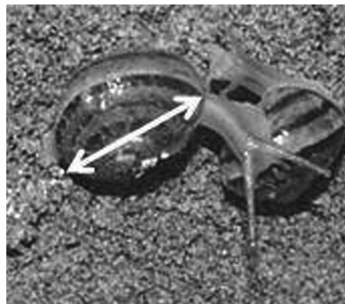
Bild 1 — Messen des Gehäusedurchmessers, d. h. des längsten Maßes, das gemessen werden kann (weißer Pfeil auf dem Foto)
