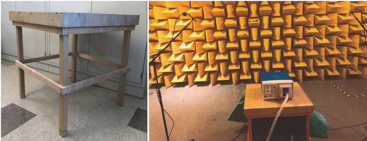
Bild 5.2 — Links: Beispiel für einen Norm-Prüftisch basierend auf ISO 7779:2018, Anhang A. Rechts: Beispiel für ein tragbares PES, das in der Prüfumgebung auf dem Prüftisch positioniert und mit einem Schalldämpfer versehen ist.
