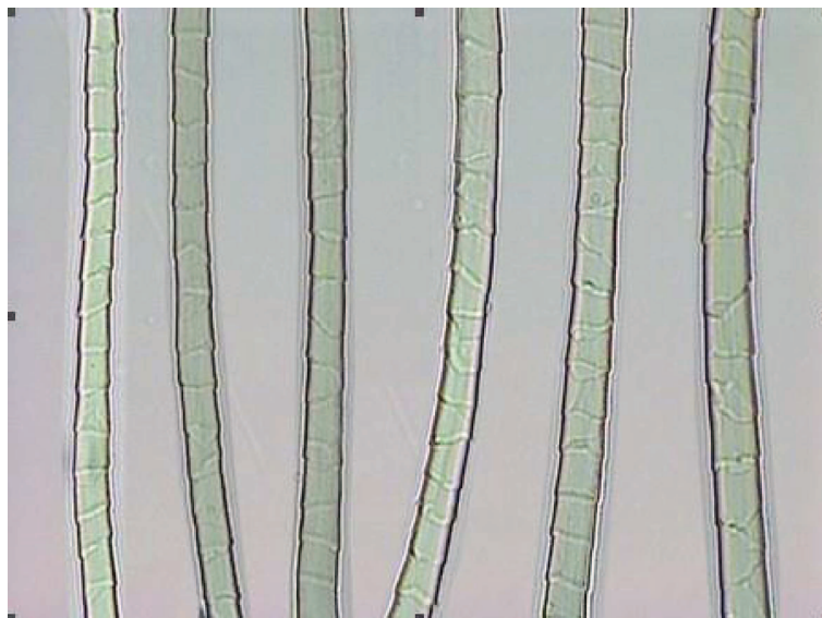
Bild C.1 — Schuppen umhüllen den Faserschaft dicht und geordnet mit glatten Rändern und zeigen regelmäßige ringförmige Muster
