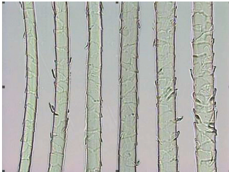
Bild C.5 — Leicht undeutliche Schuppen mit Stacheln an den Schuppenrändern, Abheben der Schuppenränder
