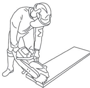
Bild 2 — Beispiel einer in typischer Trennschnittstellung gehaltenen Trennschleifmaschine
