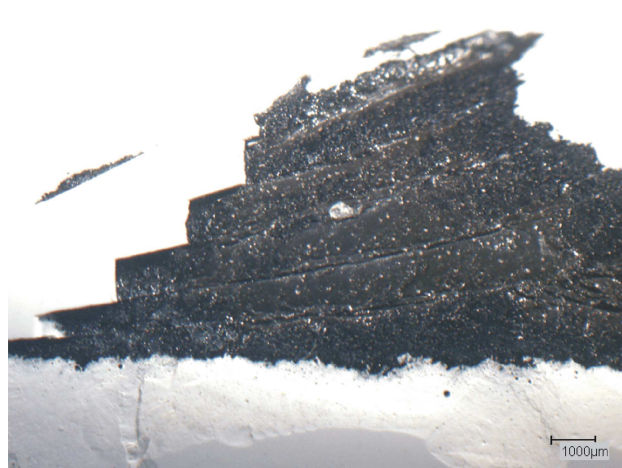
b) Abplatzung durch zu hohe Druckspannung
