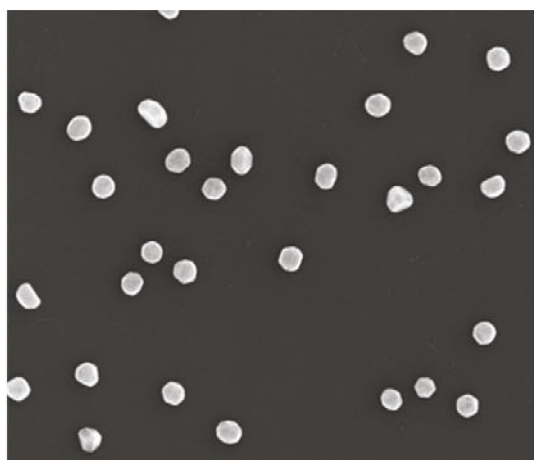
a) SEM-Aufnahme des NIST von kolloidalen Goldpartikeln RM 8013 bei 250 000-facher Vergrößerung
