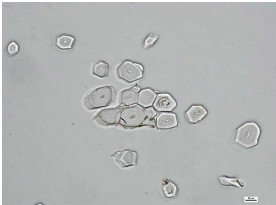
Bild A.5 — Technische Fasern (Bündel „b“) – Querschnittsansicht von unbehandeltem Flachs (LM)
