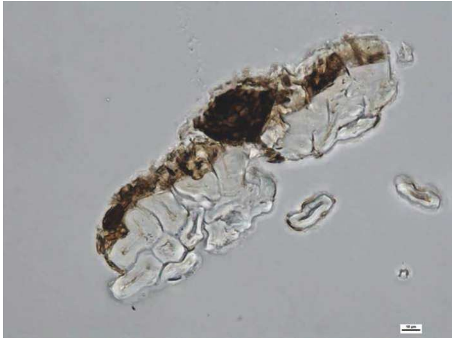
Bild A.4 — Technische Fasern (Bündel „a“) – Querschnittsansicht von unbehandeltem Flachs (LM)
