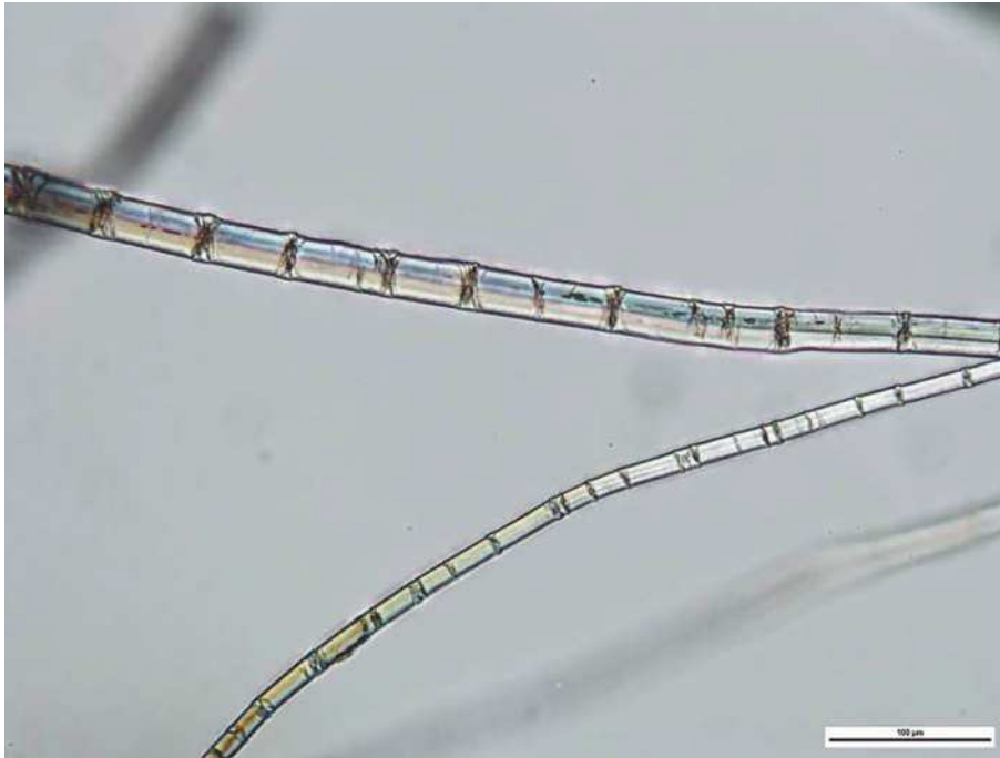
Bild A.2 — Verwachsungen — Längsansicht von Flachs-Elementarfasern (LM)
