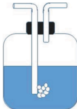
Bild 2 — PASSIVER Sprudelverdunster-ANFEUCHTER ohne Beheizung
