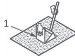
d) Ausführliche Darstellung der Entnahme einer Einzelprobe aus einem der 20 Teile bei Verwendung der in c) dargestellten Begrenzungsplatte
