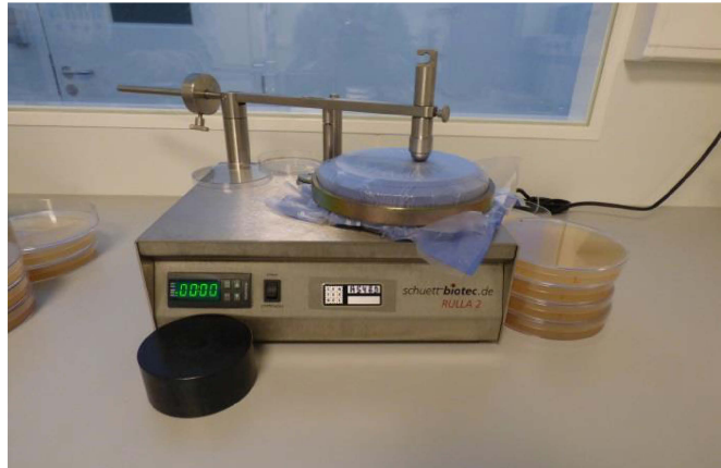
Bild 3e – Die zwischen den beiden Ringen fixierte Messprobe-Keimspender-HDPE wird über die Petrischale auf den Drehteller gestellt. Der Stahlfinger wird auf der Materialkombination genau neben dem Innenrand der Petrischale angeordnet
