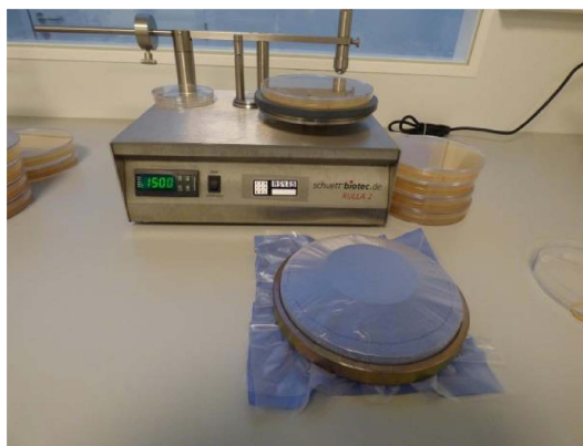
Bild 3d – Materialkombination Keimspender-HDPE zwischen den beiden Ringen fixiert
