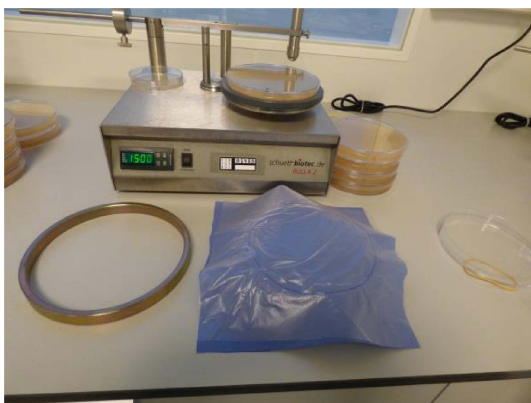
Bild 3c – Materialkombination Messprobe-Messprobe- Keimspender-HDPE-Folie auf den konischen Metallringen und dem sterilen zylindrischen Gegenstand
