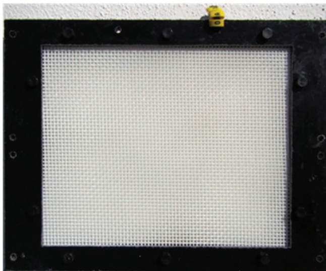
Bild 1 — Mit einem Netz aus nicht-abbaubarem Kunststoff bedeckt und zwischen zwei Rahmen aus nicht-abbaubarem Kunststoff befestigter Folien-Prüfkörper
