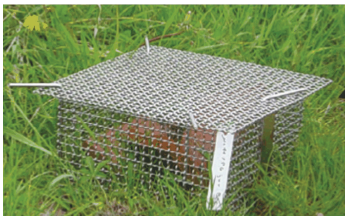
Bild F.2 — „Offene“ Mikrokosmen, abgedeckt mit Netzen, die von Stäben gehalten werden (Druart et al, 2011)
