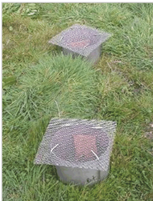
Bild F.1 — Mikrokosmen (Zylinder), abgedeckt mit Netzen, die von Stäben gehalten werden
