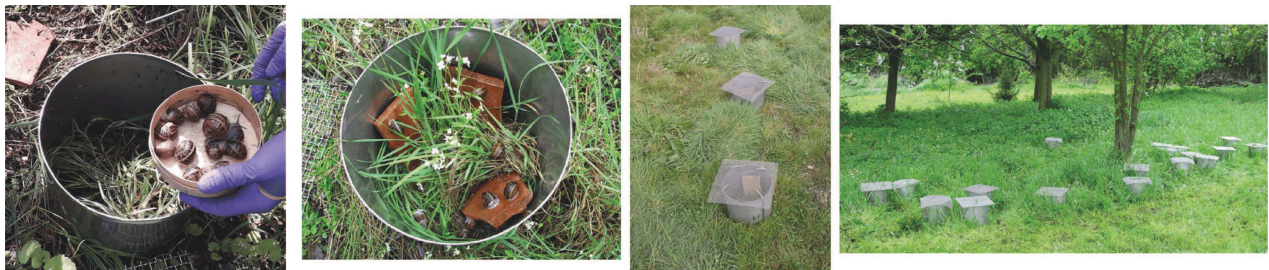
Bild 1 — In-situ-Exposition: Aktives Biomonitoring mittels Mikrokosmen, in denen Schnecken exponiert sind (von links nach rechts: subadulte Schnecke, Gesamtfrischmasse 4 g bis 6 g; offener Mikrokosmos; Mikrokosmen, die mit einem Netz aus nichtrostendem Stahl abgedeckt sind (Maschenweite: 10 mm), durch 4 Stäbe sicher über die Oberseite des Mikrokosmos gespannt; Mikrokosmen am Standort)
