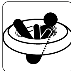
Bild 2 — Gefahr der Körpereinklemmung, wenn die Passgröße nicht stimmt
