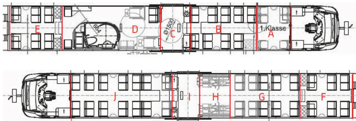
Bild 1 — Beispiel dafür, wie die Unterteilung einer DMU in die 10 Bereiche A bis J gewählt werden kann
