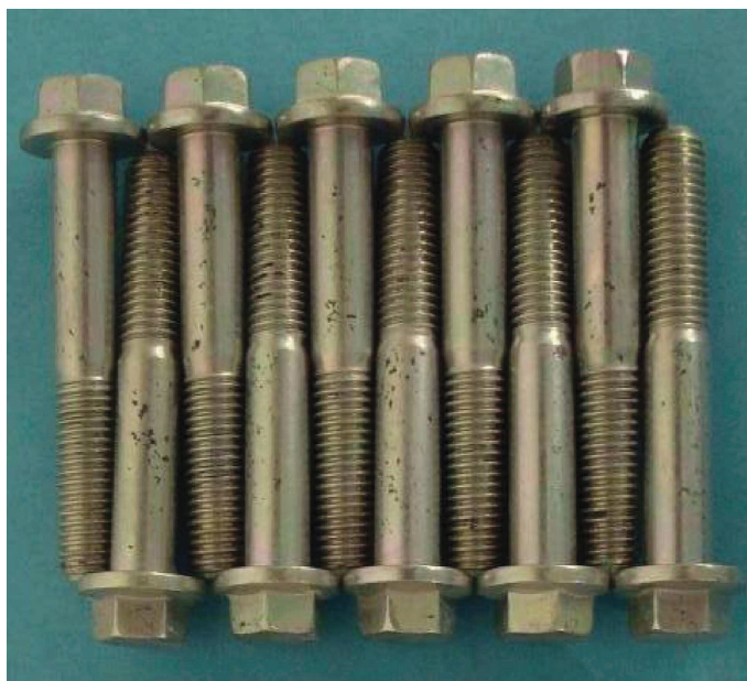
d) Schwarze Flecken nach 240 h NSS-Prüfung von Verbindungselementen mit irisierender passivierter Zinkschicht
