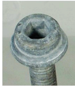
b) Zink-Nickel nach 1 000 h NSS-Prüfung
