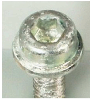
a) Weißkorrosion einer irisierenden passivierten Zinkschicht nach 240 h NSS-Prüfung
