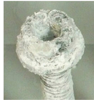
b) Starke Weißkorrosion einer irisierenden passivierten Zinkschicht nach 480 h NSS-Prüfung
